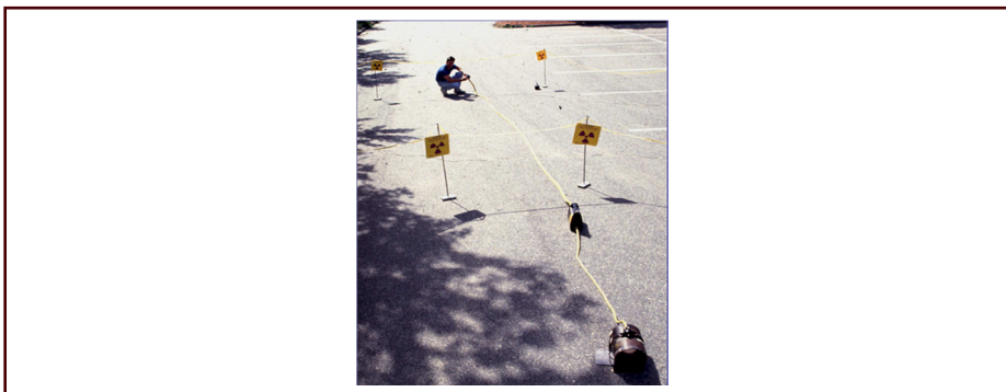
شکل ۸۱- اندازه گیری آهنگ دز در مرز ناحیه کنترل شده
