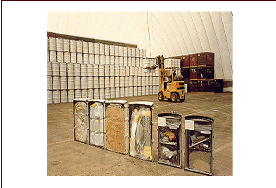
شکل ۴۶- نگهداری موقت پسمان های پرتوزا
