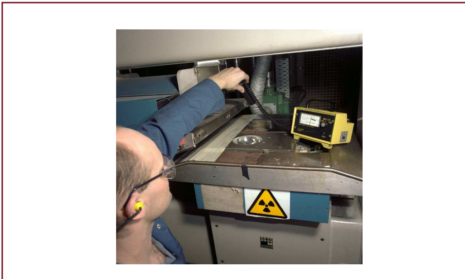
شکل ۶۰- مونیتورینگ پرتو هنگام تعمیر سنجشگر پرتوی
