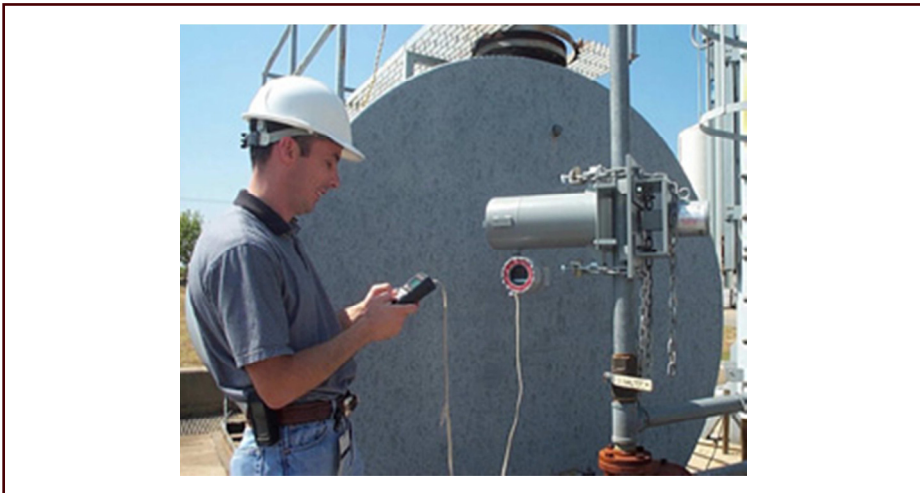
شکل ۲۲- اندازه گیری چگالی در خروجی چاه نفت
